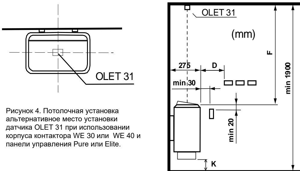
Рисунок 3 Безопасные расстояния и положение датчика
